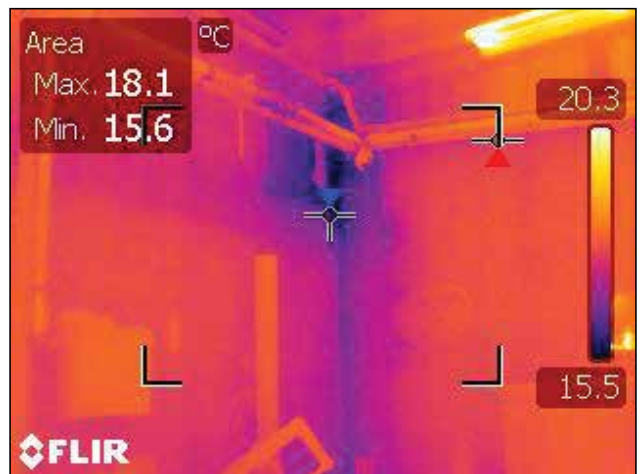
Слика 2. Термограми: део таванице изнад улаза у депо (лево) и горњи леви део; веће продирање воде и задржавање влаге у зидовима (десно)
