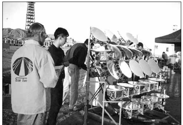
Slika 1. Grupa koncentratore – heliostata sa rastegnutom membranom i fokalno pozicioniran visokotemperaturni prijemnik
