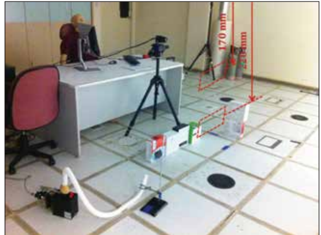
Slika 3. Zone merenja pomoću PIV-a u poprečnom preseku između dva dovodna difuzora (označenih slovima "A" i "B" na slici 1)
