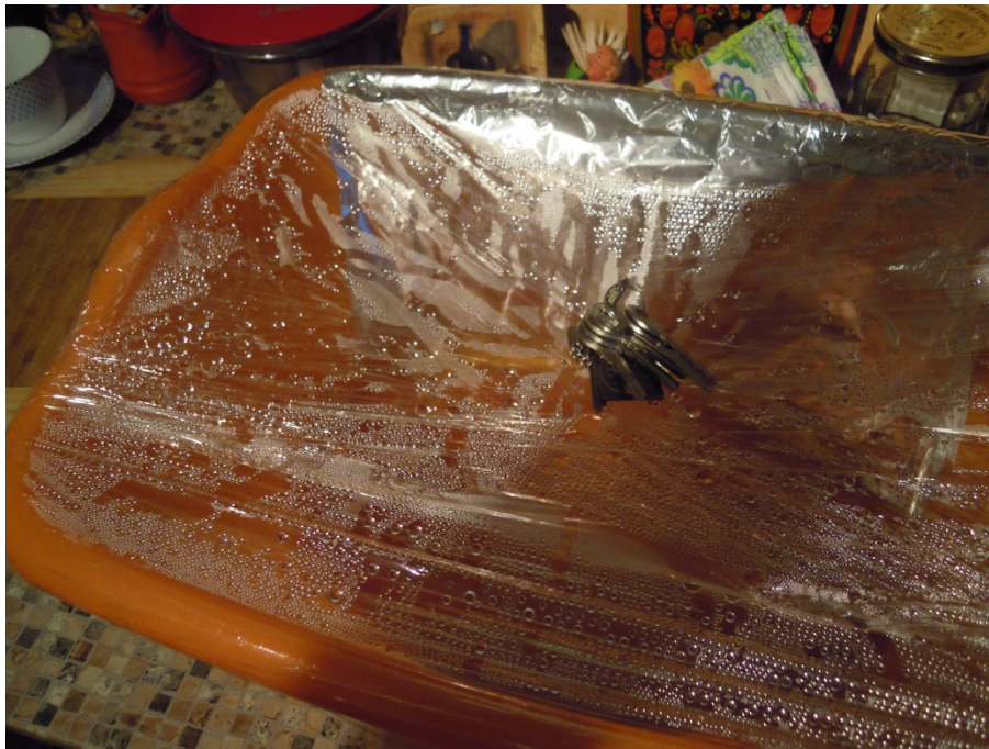
Slika 3 – Solarni destilator za pitku vodu u kućnim uslovima
