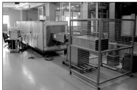
Slika 9a (levo) i slika 9b (desno). Merenje karakteristike na mernom mestu izvršeno je u skladu sa Standardom ISO 5801
