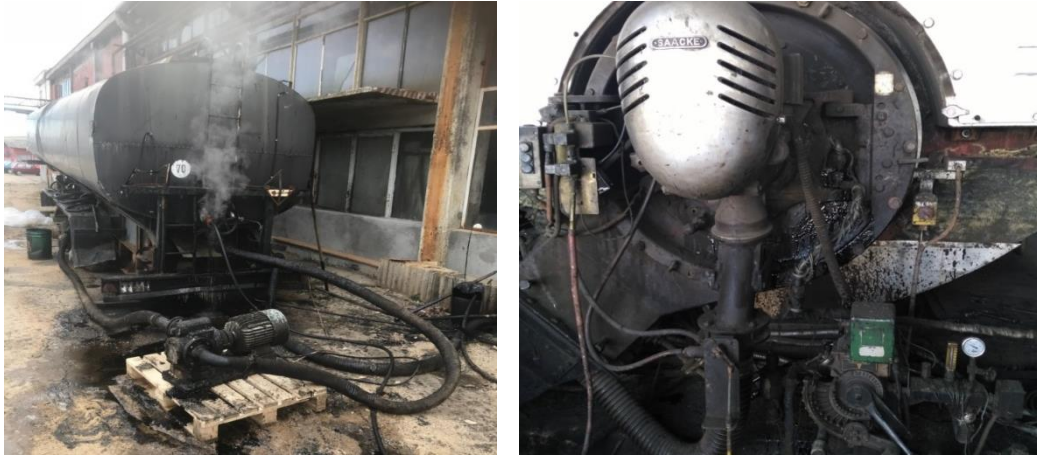
Slika 6. Mazutni gorionik i istakanje mazuta
