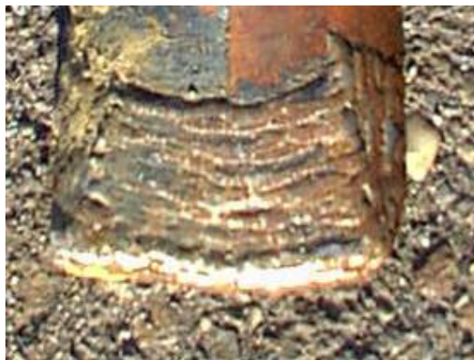
Slika 6: Stepen oštećenja navara na vrhu zuba posle 180 radnih sati
