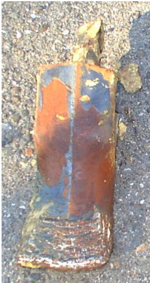
Slika 4: Stanje zaštićenog zuba posle 180 radnih sati
