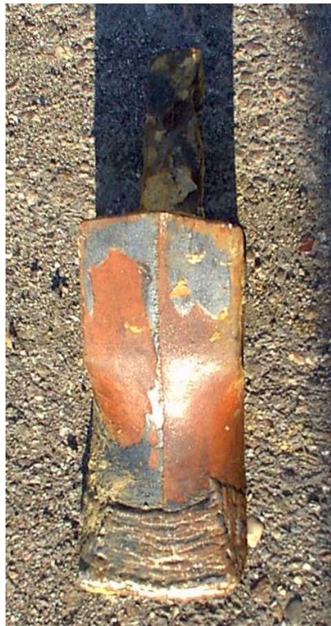
Slika 5: Stanje zaštićenog zuba posle 180 radnih sati
