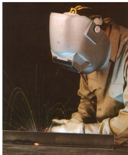
Slika5. Zavarivanje GMAV (MIG/MAG) postupkom primenom STT izvora struje za zavarivanje, koji ima kontrolisan proces prenosa materijala, smanjuje rasprskavanje materijala i emisiju štetnih dimnih gasova pa se preporučuje njegova primena u svim situacijama gde su zahtevi u pogledu kvaliteta visoki, a uslovi izvođenja kritični.
