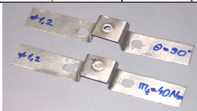
Slika 12. Izgled razorenog krstato zavarenog tačkastog spoja ( s=1.2\text{ mm} )
