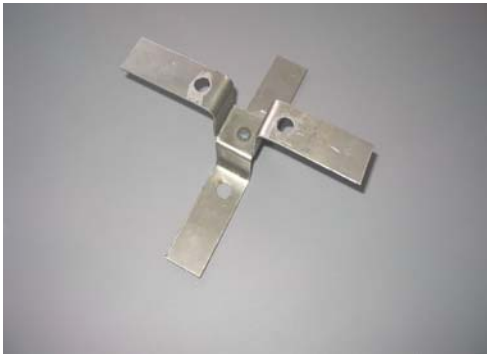
Slika 10. Izgled krstasto zavarenih epruveta različite debljina
