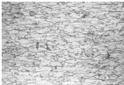
O.M. - Sitnozrna, pretežno feritna struktura sa neznatnim učešćem perlita (200 \times )
