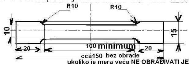
Slika 4. Epruveta za ispitivanje zatezanjem zavarenih uzoraka
